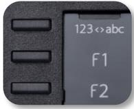
Das DeskPhone 8019s verfügt über drei vorprogrammierte Tasten für den Zugriff auf bestimmte Funktionen. In diesem Fall wird das Funktionssymbol auf das Papier gedruckt. Drücken Sie auf die entsprechende Taste, um die Funktion zu verwenden. Nach der Aktivierung bleibt die LED der entsprechenden Taste erleuchtet. Drücken Sie zum Deaktivieren auf die entsprechende Taste.
