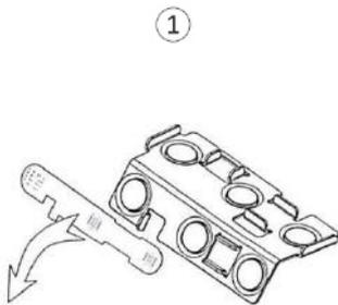
Entfernen Sie den Schutz um die Klemme des Zusatzmoduls
