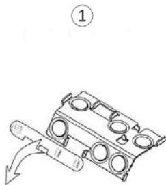
Entfernen Sie den Schutz um die Klemme des Zusatzmoduls
