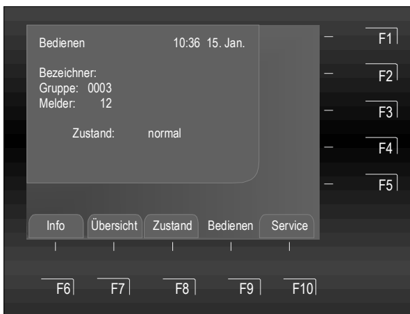
Abb. 61: Melder 12 (der Gruppe 3) - Anzeige des aktuellen Zustandes
