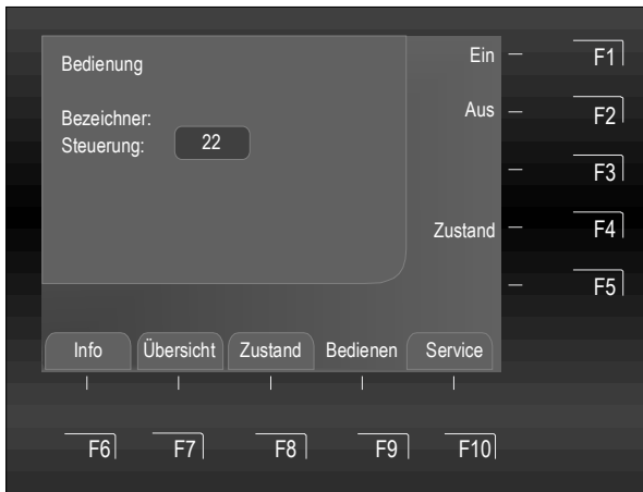
Abb. 63: Steuerung 22 einschalten/rücksetzen (Beispiel)
